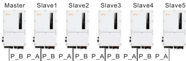
Abbildung 3.23 Parallelschaltung von Klemmen
