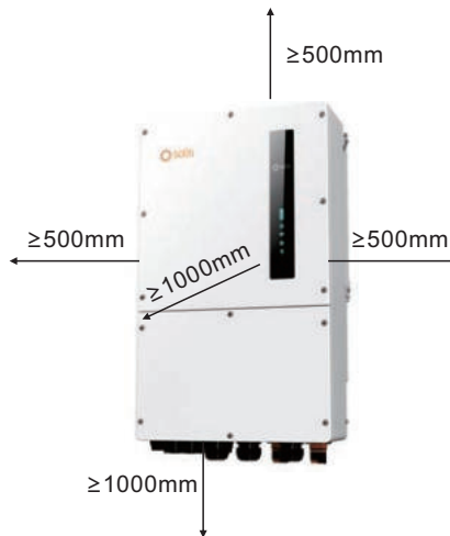
Abbildung 3.5 Montageabstände des Wechselrichters
